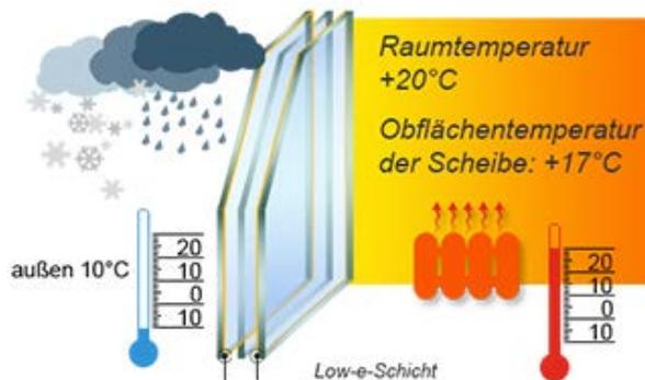
Passivhausfenster besitzen nicht nur eine gewöhnliche 3-fach Verglasung, sondern der Aufbau der einzelnen Scheiben unterscheidet sich von herkömmlichen Iso-Glasscheiben. Die innere und äußere Scheibe besitzt zusätzlich eine Beschichtung. Das macht die Verglasung zum Low-e-Glas (Wärmeschutzverglasung). Dies steht für Low Emissivity-Glas (= niedrige Wärmeabstrahlung). Die aufgebraute Metallschicht ist 100nm dick und fängt die
