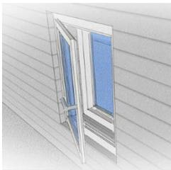
Das Kastenfenster war früher (1900 - 1950) das Nonplusultra. Zwei Fenster wurden in eine Art Kastensystem hintereinander in die Wandöffnung gebaut. Wobei jedes der einzelnen Fenster mit nur einer Verglasung ausgerüstet war. Die Kastenfenster waren aus Holz gefertigt. Einen anderen Werkstoff kannte man zu jener Zeit noch nicht.
