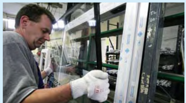
Fenster bestehen aus rund 80 Einzelteilen. Das Glas in den Rahmen zu setzen, ist nur einer von vielen Arbeitsschritten.
